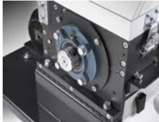
Fixação dos rolamentos
